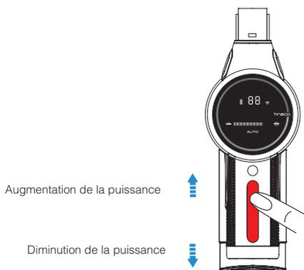
En mode AUTO, faites glisser le bouton de contrôle d'alimentation et l'appareil se mettra en mode manuel avec l'indicateur "AUTO" éteint.
