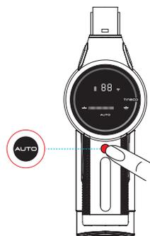
Le réglage par défaut est le mode AUTO après le démarrage de l'appareil; il mettra 3 secondes pour vérifier s'il y a un blocage puis il détectera la quantité de poussières. Si aucune poussière n'est détectée, la puissance sera réduite à la puissance moyenne.
