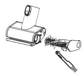
Enlevez les débris enroulés autour du rouleau avec l'outil de nettoyage des poils/cheveux Tineco
