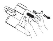
Tournez l'HEPA vers la gauche et retirez-le délicatement pour le nettoyer. N'utilisez pas l'appareil sans avoir préalablement installé le filtre HEPA.
